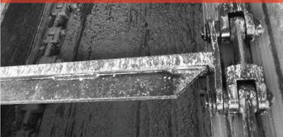
Correntes forjadas para transporte de fertilizantes e minérios. São projetadas para uso em transportadores de arraste de serviço pesado.
