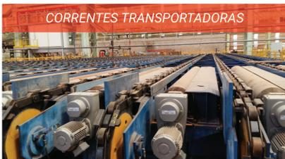
As correntes transportadoras são utilizadas em larga escala pela indústria siderúrgica, possui diversos modelos e formas construtivas, de acordo com a aplicação e necessidades requeridas.
